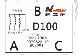
右图中 A,B,C,公共线对应底板电路上相应的接线端接入
